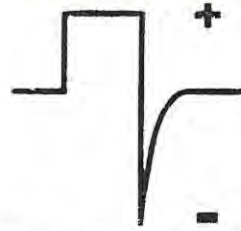
Fig. 2 L'onda quadra usata per elettro-agopuntura per stimolare in «punti» in sostituzione degli aghi da infilare nella cute, deve risultare con la semionda positiva perfettamente squadrata e con la negativa a punta come riportato in figura.
