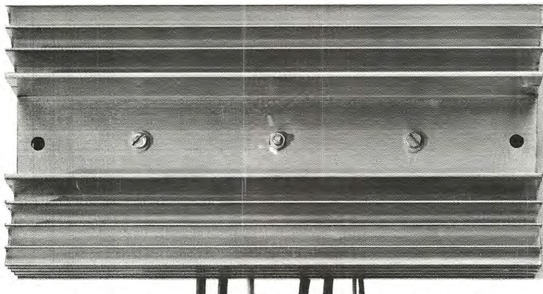
L'aletta di raffreddamento vista dal lato posteriore. Si notino le rondelle isolanti presenti sotto le due viti che serrano dal lato opposto i due darlington.
