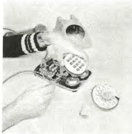
Una volta eliminato il vecchio combinatore dell'apparecchio telefonico, potrete inserire quello digitale fermanolo con le due viti.
