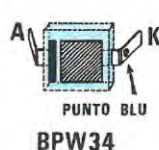
Fig. 2 Connessioni dell'integrato CD.4011 del transistor BC.237 e dei due fotodiodi che potranno essere collegati indifferentemente in questo circuito.
