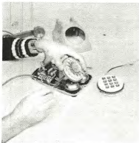
Dopo aver tolto il coperchio dell'apparecchio sviterete le due viti situate ai lati del disco combinatore meccanico e i quattro fili colorati.
